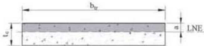
Figura 4.2 – LNE acima da fôrma
